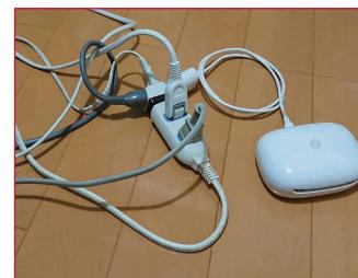
多数の分岐や電気製品があると、適正な電圧・電流値が得られず、充電不良を生じたり、LEDランプが異常を知らせる場合があります。
